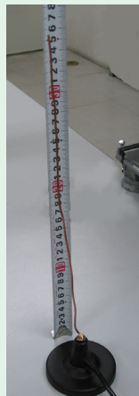
写真2: VSWRブリッジのDUT端子からアンテナに接続した様子
