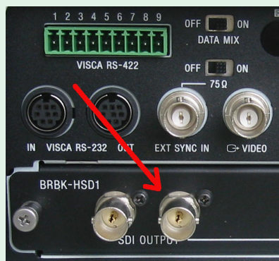
写真2:HD-SDI信号出力端子の例
