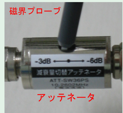
写真2:シールド特性測定風景
