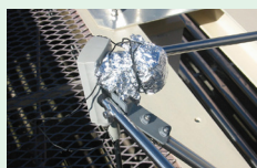
写真2:アルミ箔で覆ったLNB部
