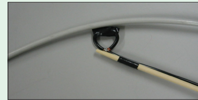
写真3:磁界プローブを供試同軸ケーブルに当て測定
