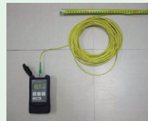
写真7: 10mの光ファイバコードを直径15cmに束ねた様子
