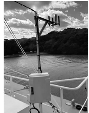
ローカル5G端末設置状況(鳥羽丸)
