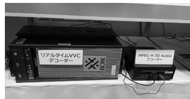
地上波デジタル1チャンネル分で、4K2チャンネルとHD 1チャンネルが送れる、新しい圧縮方式VVC
