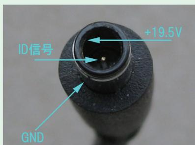
写真1:電源コネクタピン配置
