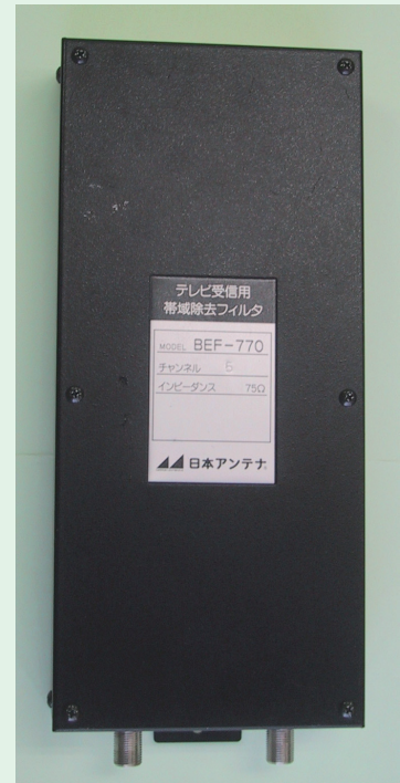
写真1:バンドエリミネートフィルタ(BEF)の外観
